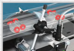
Каретка режущей головки оснащена восьмью (8-ю) шарикоподшипниками
